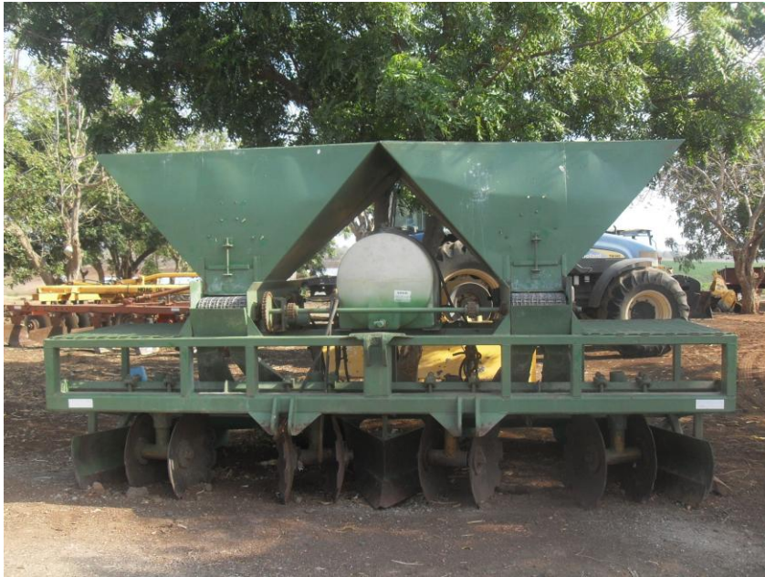
Figura 8. Encamado/fertilización edáfica, forma las camas y fertiliza, ya que tiene una tolva incorporada.
