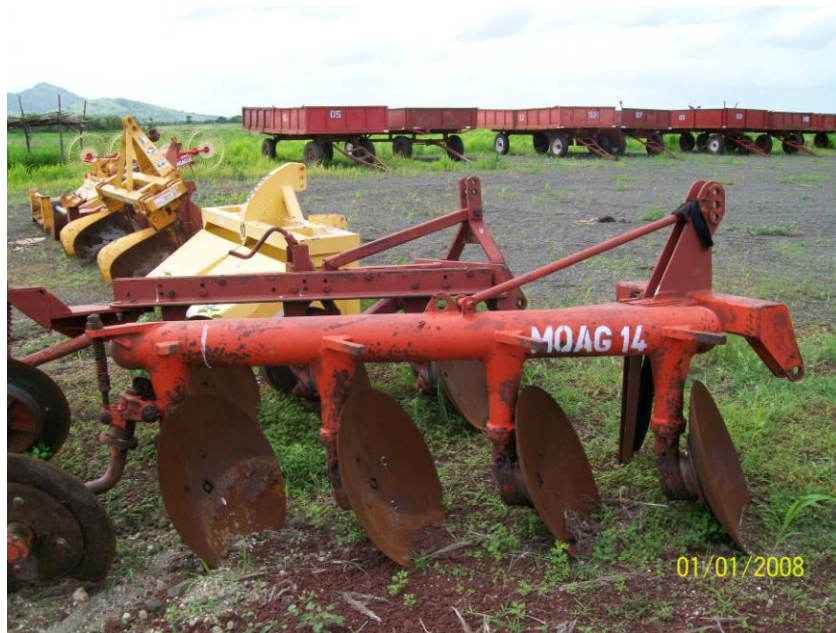
Figura 5. Arado, corta, profundiza a 12" y revuelve la tierra.
