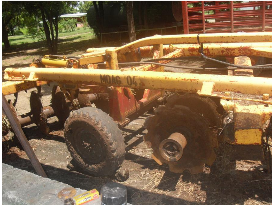
Figura 6. Rome Plow, corta verticalmente y profundiza a 8"
