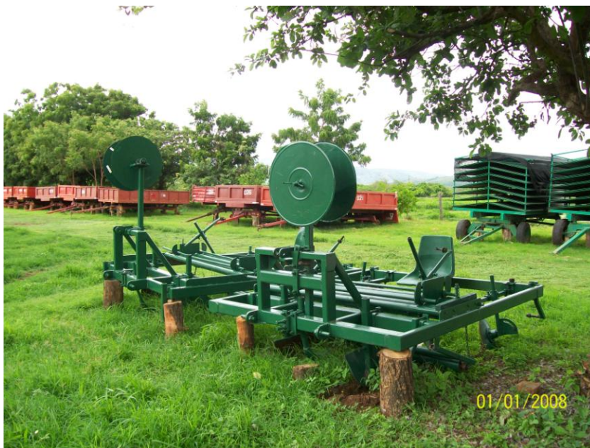
Figura 10. Emplastadora, coloca el plástico en la cama y lo tapa, juntamente con la cinta de goteo.
