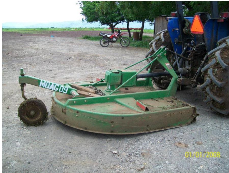
Figura 4. Chapodadora, su función es cortar la maleza a una altura indicada al operador
