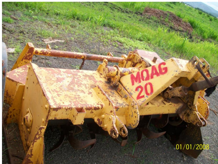
Figura 9. Rotabator, desmenuza los terrones de las camas y dispersa el fertilizante en la misma.
