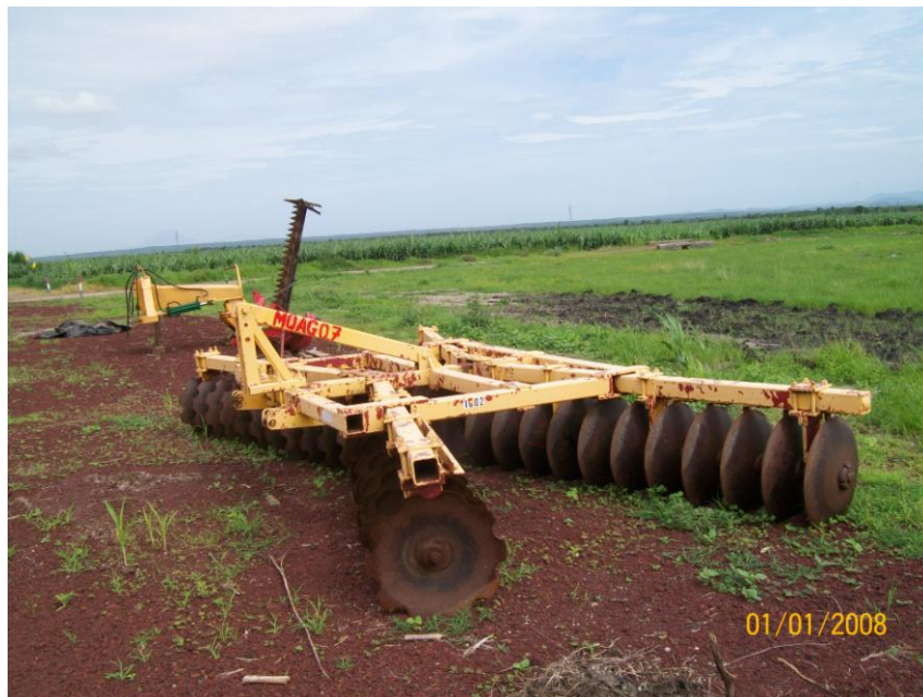
Figura 7. Grada, se utiliza una o dos pase, con el objetivo de afinar el terreno al máximo.
